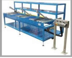
Double mouvement pneumatique sécurisé par action sur une commande bimanuelle
